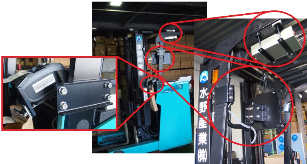
左：イーソル製モバイルプリンタホルダ、右上：電圧変換ボックス、右下：タブレット端末ホルダ (水野産業 関東物流センターにて撮影)
